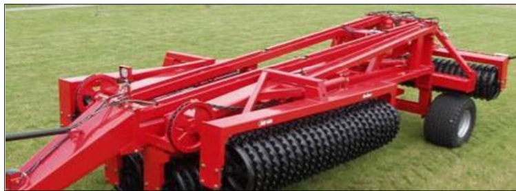
King-Roller 15,30 m. Monteret med 620mm/24" Cambridgeringe
