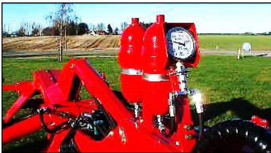
**Manometer für Druckjustierung auf 2-Längen Maschinen**
