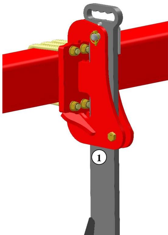
Wenn der Sicherungsschraube springt und der Zinke ausgelöst gewesen ist muss die Schraube (Pos. 1) ausgewechselt sein
