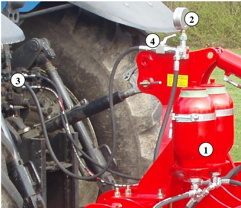
1. Ehe jeder Saison-Anfang wird es empfohlen, dass der Gasdruck der Akkumulatoren (Pos.1) 110 bar ist.
