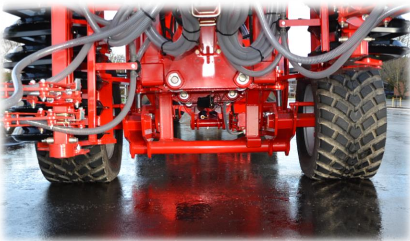
Billede 2. Transportben hviler på hjulstel.
