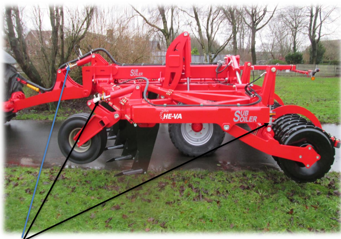
Billede 7. Arbejdsdybden justeres med clips.
