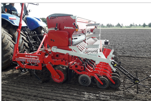
Combi-Seeder VF 4,00 m avec disques semeurs
