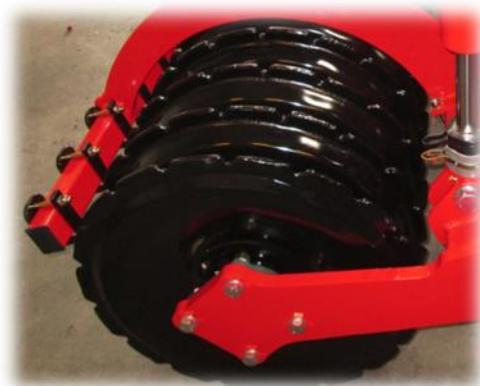
Il Sub-Tiller ha raschiatori speciali progettati tra gli anelli packer sul rullo con profilo a V. Per evitare inutili usure e ottenere il migliore risultato dai raschiatori è importante verificare la centratura dei raschiatori ogni giorno
