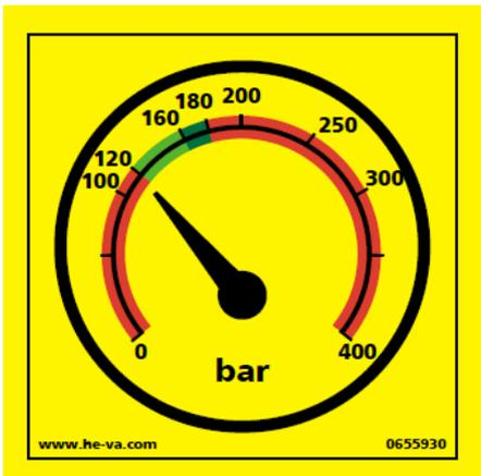
Presión hidráulica correcta en el sistema hidráulico.
