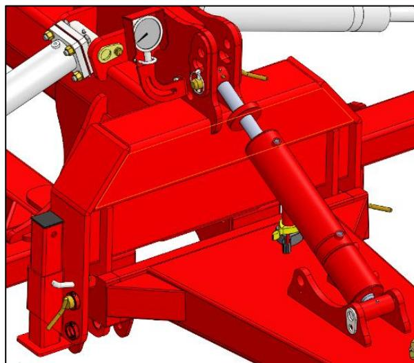
Via Memory Cylinder kan maskinens parallelitet med jordoverfladen justeres under kørslen. Herved sikres det, at redskabet arbejder i linje efter traktoren, selv i kuperet terræn.
