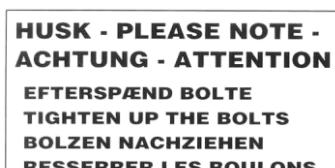
Efterspænd alle bolte efter kort tids brug. Hvis dette ikke overholdes, bortfalder vore garantiforpligtelser.
