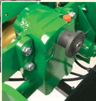
Die Übersetzung des Getriebes ist 2,1 : 1 (Motordrehzahl 2100 = Frontzapfwelledrehzahl 1000) und die Drehrichtung ist rechts in Fahrtrichtung.
