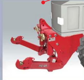
Mit einem Sperrbolzen kann der Schlepperfahrer – je nach Arbeitsaufgabe – die Unterlenker in drei verschiedenen Positionen einstellen. Mit dem Sperrbolzen wird gewählt, ob die Unterlenker starr sein sollen oder der Pendelausgleich mit oder ohne Begrenzung wirken soll. Wenn die Fronthydraulik nicht gebraucht wird, können die Unterlenker aufgeklappt und durch die Hydraulikzylinder verriegelt werden.
