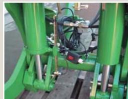
Der Hub der Unterlenker ist mittels eines Fühlers einzustellen, was ermöglicht, die Unterlenker in einer bestimmten Position zu stoppen.
