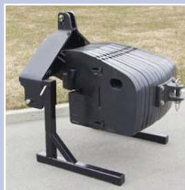
2000 kg. Frontgewichtsträger für den Anbolzen vom Grundrahmen des Schleppers oder für direkte Montage der Frontgewichte. In der Schlepperfarbe lackiert und mit abnehmbaren Stützbeinen.
