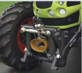
Die Frontzapfwelle ist für die meisten Schlepper- und Fronthydraulikmodelle entwickelt. Sie hat eine integrierte Ölpumpe – deshalb kein Eingriff in die Hydraulik des Schleppers. Eine im Ölbad laufende Lamellenkupplung, die von der Kabine elektromagnetisch eingeschaltet wird, überträgt die Motorenleistung auf die Frontzapfwelle.
