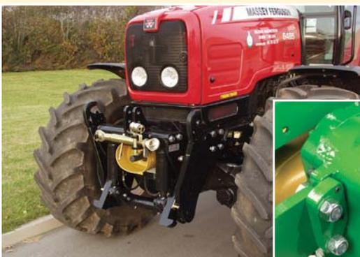
Das Getriebe ist direkt an der Kurbelwelle des Schleppers mit einer Gelenkwelle und einer schwingungsdämpfenden Gummikupplung montiert. Elektrohydraulische Einschaltung mit weicher Anlaufphase über eine Lamellenkupplung im Getriebe. Eine integrierte Ölpumpe fördert den notwendigen Öldruck zur Ansteuerung der Lamellenkupplung.
