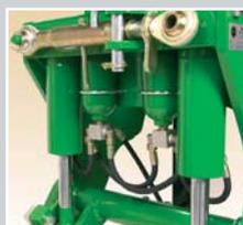
2 Ausgleichbehälter – mit je 15 Bar Vorspannung (1 beim Anheben und 1 beim Absenken).
