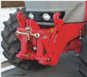
Die 5.500 kg Fronthydraulik ist die Größte des Programms. Sie wurde entwickelt, um die großen Anforderungen auch bei den größten Schleppern zu erfüllen – ohne die Funktionen des Schleppers einzuschränken. Empfohlen für Schlepper ab 150 PS.
