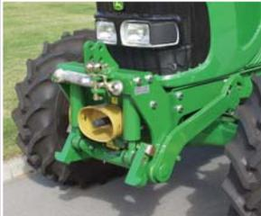
Auch die 2.500 kg Fronthydraulik ist hervorragend an den Schlepper angepaßt, um Stabilität und eine einfache Montage zu erreichen. Empfohlen für Schlepper zwischen 70 und 130 PS.
