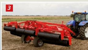
Der Zylinder des Fahrgestells wird autom. aktiviert - die Räder vorwärts drehen und aufheben (1. Anschluß)
