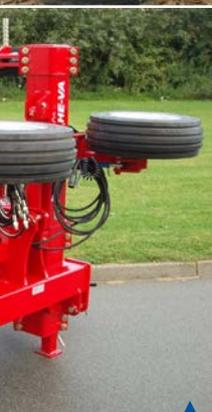
**L'attelage à réglage hydraulique avec crochet d'attelage** - permet d'utiliser le Combi-Tiller MKII en solo, attelé au relevage du tracteur, ou, combiné à un appareil traîné.
