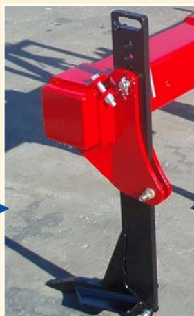
La profondeur de travail est réglable manuellement (Pas de 50mm). Ce dispositif permet également de sécuriser les dents au transport en les relevant.
