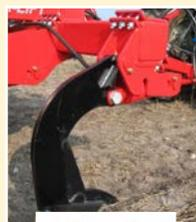
**Sécurité hydraulique non-stop** - un vérin fixé sur chaque dent de l'appareil est relié à deux accumulateurs à gaz amortisseurs. Après un contact avec un obstacle, la dent revient automatiquement à la position de travail. Un manomètre permet de vérifier la pression.
