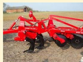
**Attelage hydraulique** - Le Combi-Tiller MKII est équipé en standard d'un attelage hydraulique. Il permet d'adapter à l'attelage trois points Cat. 2 / 3 un outil semi-porté. L'attelage assure ainsi le rôle de contrôle de profondeur des dents Combi-Tiller MKII.
