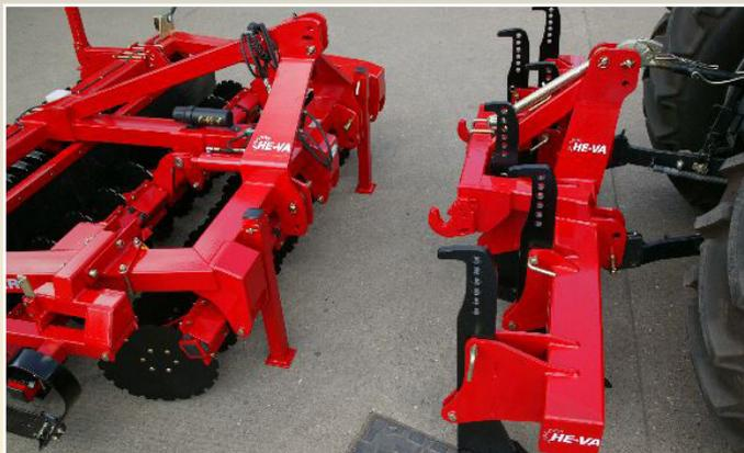
L'attelage automatique permet d'atteler facilement et rapidement un autre outil porté, comme par exemple, le Disc-Roller de HE-VA.
