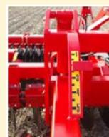
En combinaison avec le déchaumeur Disc-Roller de HE-VA, le Combi-Tiller MKII travaille de 50 mm jusqu'à 300 mm de profondeur.
