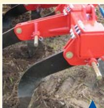
**Sécurité mécanique Quick-Push** - Un boulon avec des amorces de rupture. En présence d'obstacles la dent sectionne la sécurité. L'utilisateur repositionne le boulon jusqu'au point de rupture suivant.
