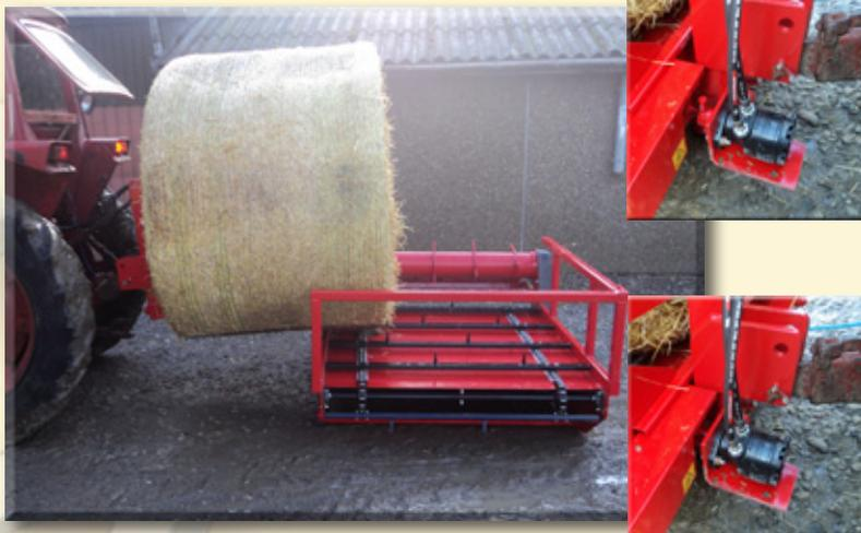
Une technicité particulière de cette Chargeuse Dérouleuse c'est composée de deux parties: D'un ensemble avec un tablier fermé muni d'un fond mouvant à chaînes, avec des pointes très acérées. Un rouleau démêleur très agressif, assurant la distribution. D'autre part un attelage trois points, muni d'une fourche à deux dents renforcées, pouvant servir de fourche arrière. Cela permet d'aller prendre sur le lieu de stockage une balle ronde, pour la déposer sur le tablier de la Dérouleuse.
