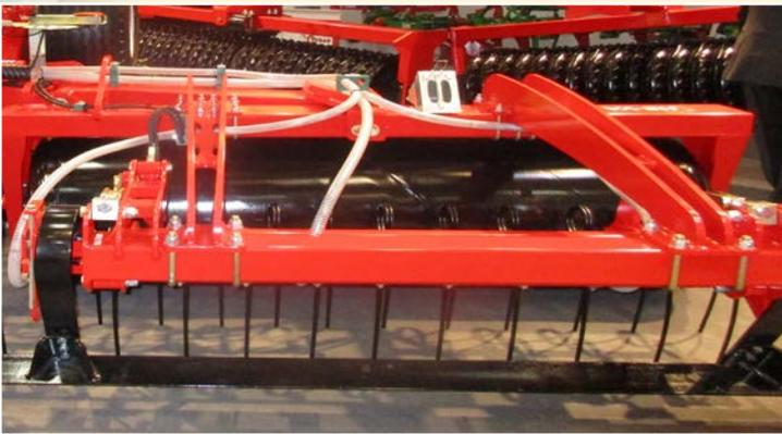
Für intensive Ausgleichung der Grasländer, kann ein justierbare Planierschiene auf 2- und 4-reihen Modellen montiert werden.
