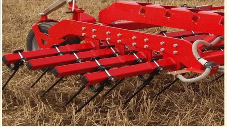
Nach dem Ernte verteilt der Top-Strigle die übrig gebliebenen Strohen und indem die Strohen in die Sonne liegen, wird der Auswuchs-Prozess voran getrieben. Das herstellt die besten Bedingungen für Mulchsaat im Frühjahr.
