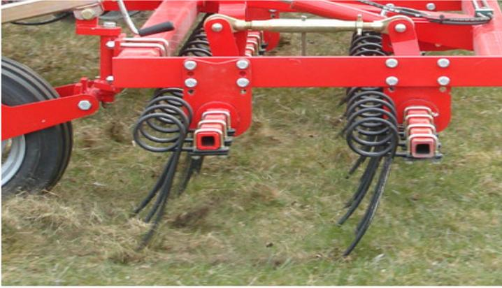
Der Top-Strigle frischt nach der Wintersaison die Wiese auf, indem die Maschine die Oberfläche zerteilt, so dass Sauerstoff zum Wurzelbereich transportiert werden und damit hilft den Sauerstoff zu machen um Auswuchs der Samen beizubringen.
