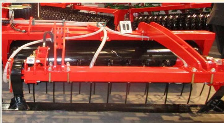
Pour le nivellement intensif des prairies, une planche de nivellement optionnelle peut être montée sur des modèles à 2 et 4 rangées et elle est totalement ajustable.
