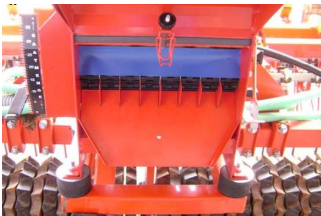
4. Monter indsåningstragt under doseringvalse
