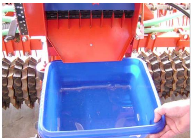
5. Placer kalibreringsbeholder under indsåningstragt
