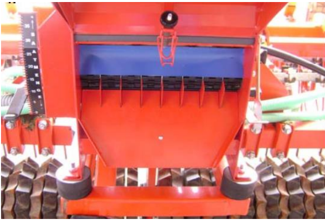
4. Rutsche unterhalb der Dosierwalze einhängen
