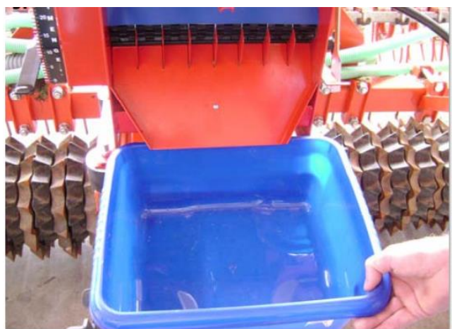
5. Placera behållaren under vridprovstratten
