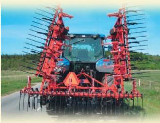
Während Transport werden die Seitensegmente über senkrecht gehoben, um die Egge so schmal wie möglich zu machen. Die Transportbreite ist immer unter 3,00 m.
