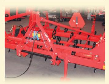
Kulti-Dan ist mit Schnellkupplung ausgerüstet, die das An- und Abkopplung vereinfacht. Mittels der Stütze wird die Egge leicht abgestellt.
