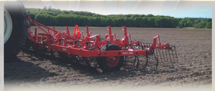
Kulti-Dan ist eine vielseitige Saatbeetegge für Dreipunktanbau, die mit einem breiten Zusatzausrüstungsprogramm dem Bodentyp sowie Schlepper des einzelnen Betriebs angepaßt werden kann. Die großen Räder tragen die Egge auf leichtem Boden, und ein hohes Eigengewicht gewährleistet die korrekte Arbeitstiefe auf sogar dem schwersten Boden.
