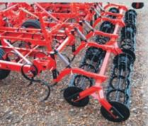
Eine Rückverfestigung der aufgeeggte Erde wird durch den Krümler / Doppelkrümler gewährleistet, so daß die Feuchtigkeit bewahrt und große Krusten aufgebrochen werden. Der Druck der Krümler wird mittels der Federn eingestellt.
