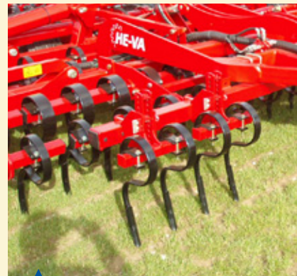
Dents efface traces 2x4 dents montées devant Spring-Board et rangée de dents.
