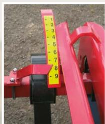
L'échelle graduée visible depuis la cabine du tracteur permet de contrôler l'angle de travail.
