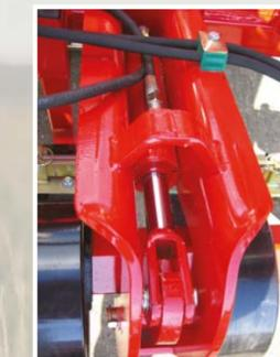
Toutes les lames des planches niveleuses Spring-Board adaptées sur les rouleaux poussés sont réglables hydrauliquement. L'agressivité des socs palettes ou fourches est déterminée par les conditions de travail, ils peuvent être totalement escamotés selon besoin.
