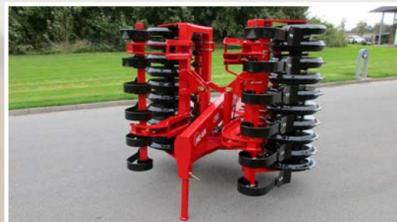
Eine Besonderheit ist der hydr. klappbare Front-Roller 3m. Er zeichnet sich durch eine kompakte Transportbreite aus, welche gerade bei engen Durchfahrten und längeren Straßenfahrten von Nutzen ist.
