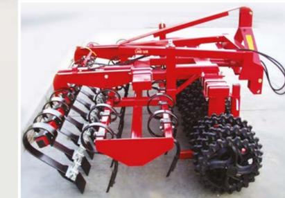
Bei den 1-teiligen Front-Roller-Modellen können auch Frontegge und Spring-Board kombiniert werden (s. Abb.).
