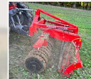
Für die Stoppel- und Zwischenfruchtbearbeitung kann der Front-Roller auch mit der Top-Cutter Messerwalze ausgestattet werden. Diese verfügt über schräg angeordnete Messer aus spezialgehärtetem Stahl, welche auf einem geschlossenen Walzenkörper angebracht sind. Dieses sorgt für eine Leichtzügigkeit und beugt dem Verstopfen vor.
