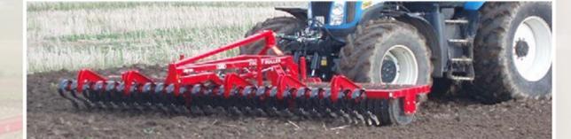
Toutes les lames des planches niveleuses Spring-Board adaptées sur les rouleaux poussés sont réglables hydrauliquement. L'agressivité des socs palettes ou fourches est déterminée par les conditions de travail, ils peuvent être totalement escamotés selon besoin.
