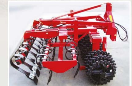
La combinaison Spring-Board et vibroculteur frontal permet de travailler sur tous types de sol (Front-Roller modèles rigides uniquement).
