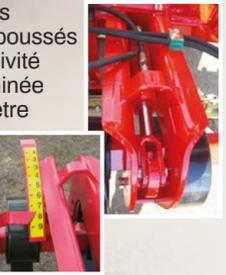
Le vibroculteur frontal avec 2 rangées de dents en S, réglables en hauteur, est adaptable sur tous les rouleaux poussés. 2 manivelles de réglage permettent de positionner les dents à la profondeur requise.
