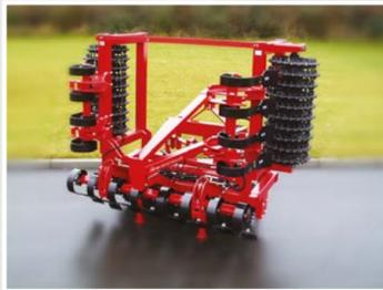
Les modèles à repliage hydraulique sont aux largeurs de 4,00 m, 5,00 m et 6,00 m.
