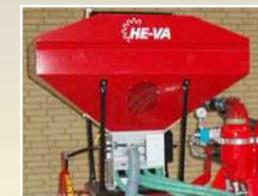
Conçu spécialement pour l'engrais, ce modèle est doté d'un fond de trémie en acier inox et d'une boîte de vitesse renforcée. Les mod. FZ sont disponibles en 410 l, 660 l et 850 l.
