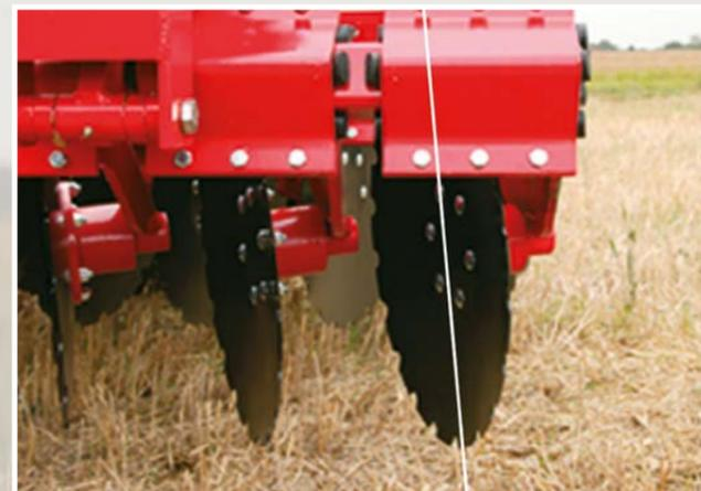
Mit etwa 1 Tonne pro Meter wird sehr effektive Schneidwirkung in Verbindung mit einer sehr wirkungs-vollen Verdichtung für die weitere Bearbeitung erreicht.
