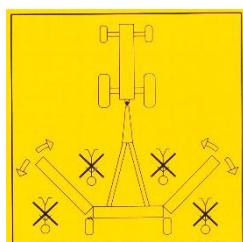
Veiller à ce que personne ne se tienne dans la zone hazarduse en repliant et dépliant la machine.
