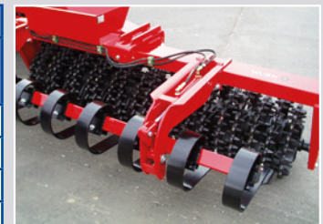
Hydr. verstellbarer SPRING-BOARD vor den Crosskillringen.
