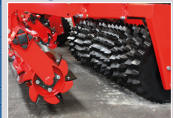
Top-Cutter vor Tip-Roller mit Sternringen.
