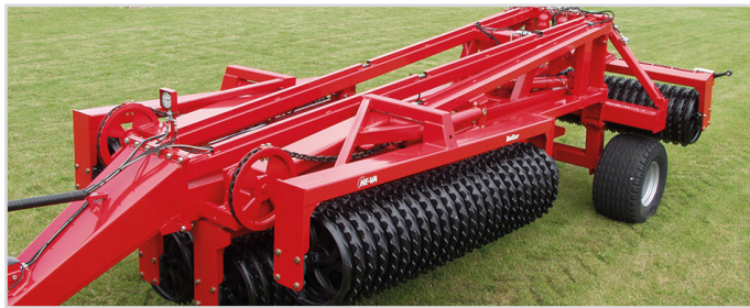
15,30 m King-Roller monterat med 620 mm/24" Cambridgeringe
