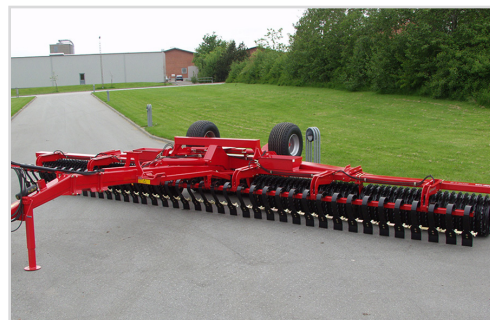
10,20 m avec anneaux Cambridge 620 mm/24" Spring-Board et barres de liaison des lames
