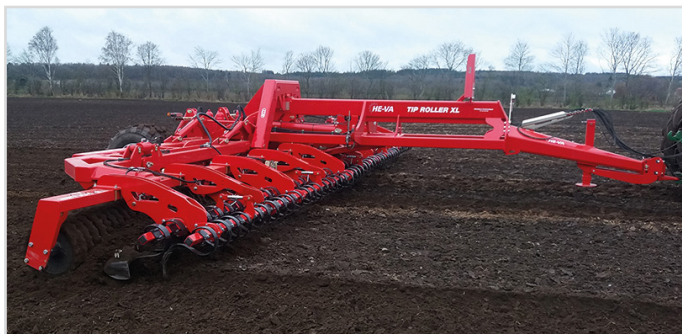
12,30 m Tip-Roller XL avec anneaux Cambridge et Spring-Board double.
