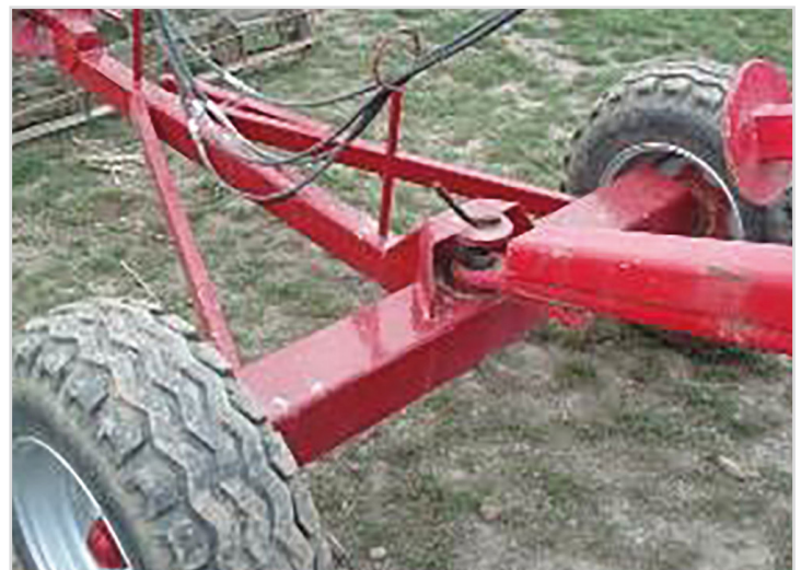
Dolly: Radsatz, der eine Ankupplung von Walzen hinter der Egge ermöglicht – 11.5/80 x 15.3 Rad.
