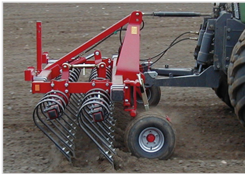
4,00 m Front-Board mit Krustenbrecherscharen.
