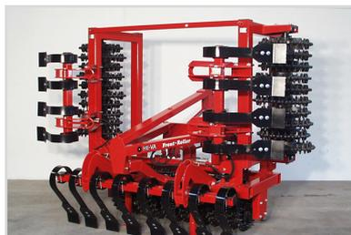
4,00 m Front-Roller m/ Crossskill, hydr. Klappung und Spring-Board.
