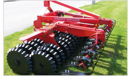
3,00 m Front-Roller Twin mit Ø550/550 mm Sternringen und Spring-Board.
