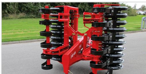
2-teilige 3,00 m Front-Roller mit V-Profil, hydraulische Klappung und Spring-Board
