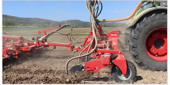
Le Combi-Tiller HE-VA est un décompacteur utilisable en solo ou combiné avec un appareil traîné. Il fissure le sol sans bouleverser la structure pour permettre l'utilisation des outils de préparation. Dents positionnées en quinconce de 420 mm entre dents, contrôle hydraulique de la profondeur, profondeur maxi 400 mm, mini 100 mm.
