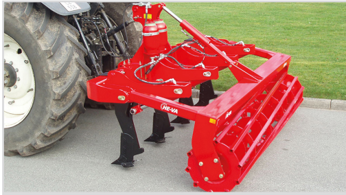
3,00 m m/hydraulisk stenutlösning, 4 pinnar, rörvals och hydr.djupreglering.
