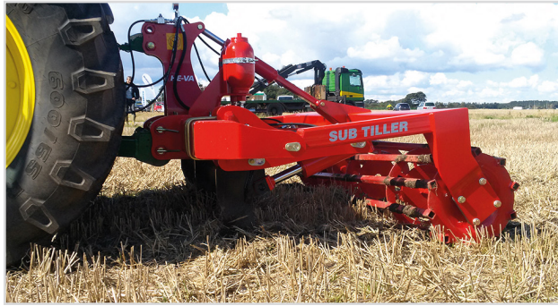
3,00 m. m/hydraulisk stenutlösning och 4 pinnar.
