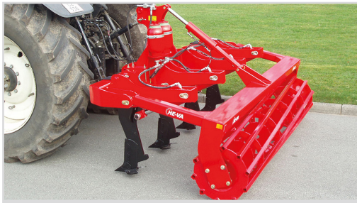
3,00 m med hydr. auto. udløser, 4 tænder, svær rørvalse og hydr. dybderegulering
