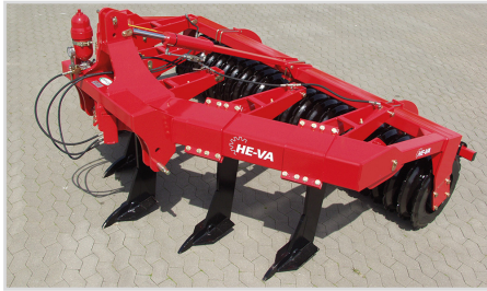
3,00 m rigide, 5 dents, avec anneaux V-profil et sécurité automatique hydraulique
