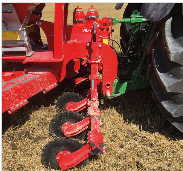
Bâti de Disque avec les disques Ø470mm montés
