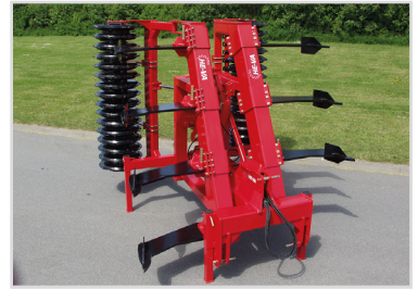
4,00 m Sub-Tiller m/hydr. sammenklap, 7 tænder, V-profilringe og Quick-Push
