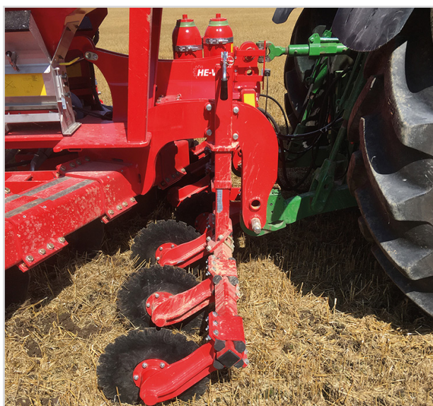
Ramme for rulleskær med rulleskær Ø470 mm.
