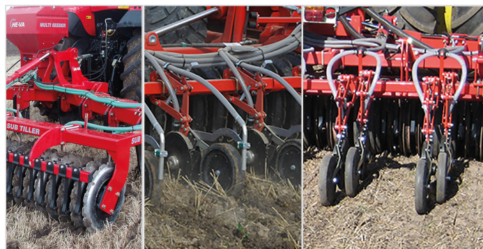
Skiveskærs-såning (12 cm. ml./skiveskær) med 75mm brede dybdehjul/pakkerhjul. Placeret i 2 rækker pr. tand. En række på hver side af grubbesporet efter pakkervalse.
