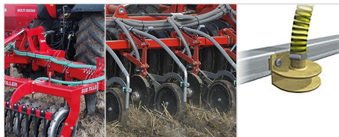
Aussaat mit Scheibenscharen mit 75 mm breitem Tiefenrad / Packerrad. Platziert in einer Reihe pro Zinke nach der Packerwalze.
