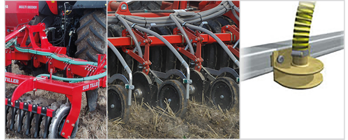
Skiveskærs-såning med 75mm brede dybdehjul / pakkerhjul. Placeret i 1 række pr. tand efter pakkervalse.
