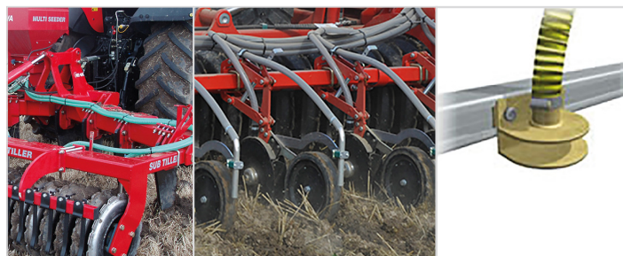
Skiveskærs-såning med 75mm brede dybdehjul / pækkerhjul. Placeret i 1 række pr. tand efter pakkervalse.
