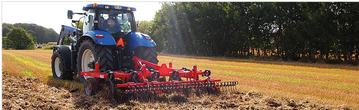
4,00 m Triple-Tiller Airy med fjedertænder.
