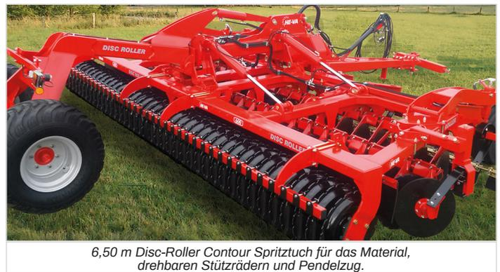
6,50 m Disc-Roller Contour Spritztuch für das Material, drehbaren Stützrädern und Pendelzug.
