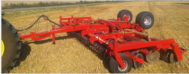
8,00 m mit V-Profilwalze und lenkbaren Stützrädern
