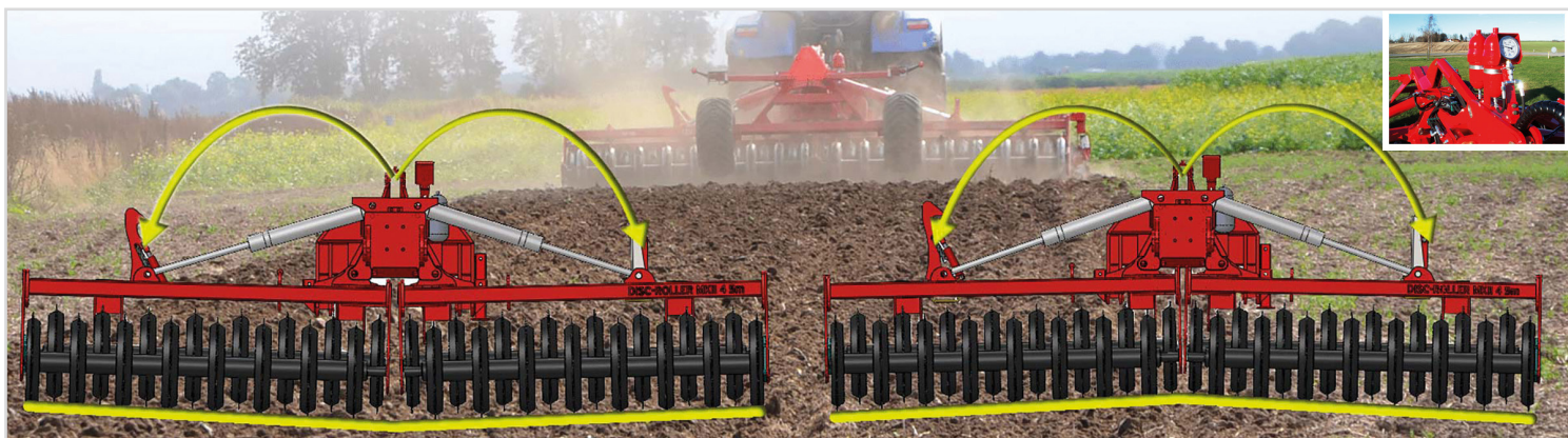
Standardutrustning på 2- och 3-sektion modeller: HE-VA SAT-System: Hydr. justerbar viktöverföringssystem, som säkrar en jämn vikt-överföring på hela arbetsbredden och som samtidigt påverkar att sidosektionerna följer marken.
