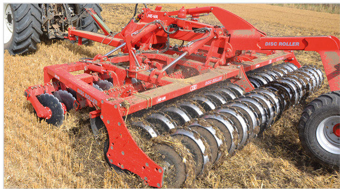
5,50 m Disc-Roller Contour m/Twin V-Profilvals och material-dämpare.
