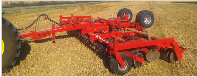
8,00 m Disc-Roller Contour med V-Profilvals och roterbara stödhjul.
