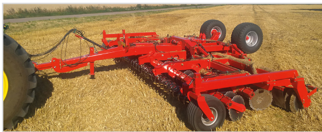
8,00 m Disc-Roller Contour avec rouleau V-Profil et roues support tournantes.
