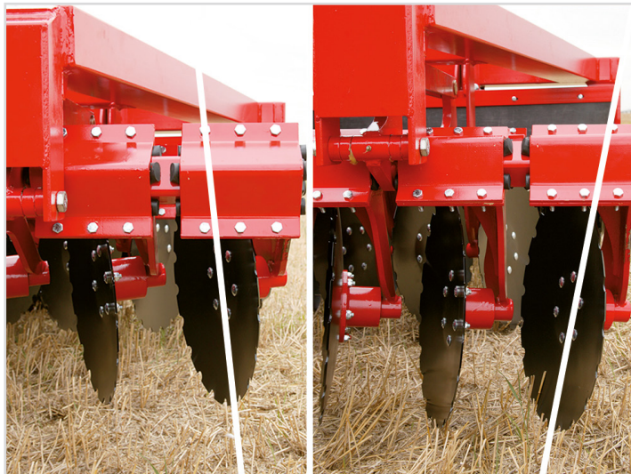
Standardudstyr på alle modeller: "DSD": Dybde Synkron Disc-aggressivitet.
