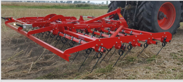
6,00 m Top-Striegel mit 5 Reihen und 16 mm Zinken
