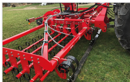
Lame niveleuse avec réglage de la hauteur par manivelles
