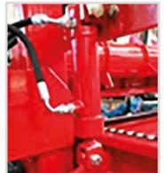
Verrouillage hydraulique du tablier démêleur
