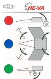
Identifikationsmærker for maskinens hydrauliksystem:
